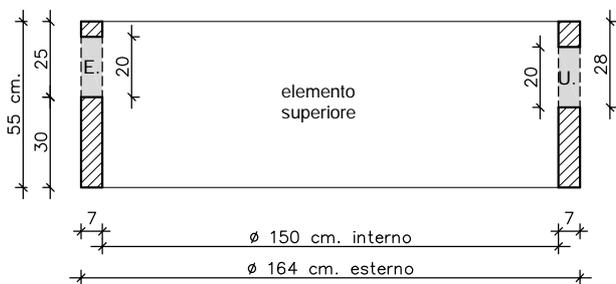
sezione A-A sc. 1:25 elemento superiore
